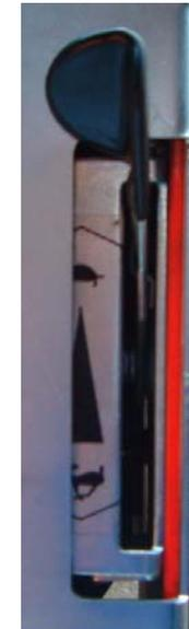
Stellung des Hebels bei Motorstop
