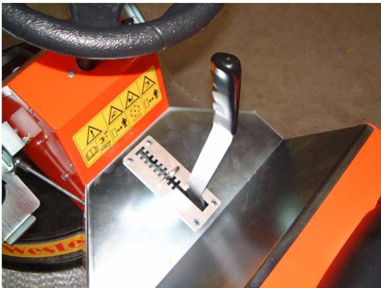
**Bei Nichtbenutzung, die Bürste ausgehoben positionieren !**
